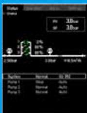
コントローラは流量計を使用することなく、ポンプの性能曲線データを用いて流量を推定できます。これによってシステムの稼働状態を把握したり、配管の破損を示唆するような不規則な水の消費量に気付いたりすることが可能になり、高価な流量計は不要になります。
