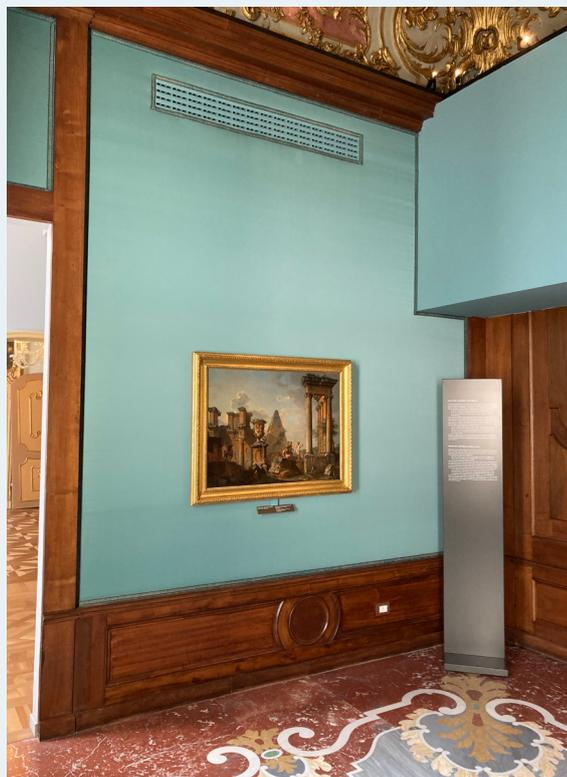
Le bocchette dell'aria per il riscaldamento e la climatizzazione sono state verniciate dello stesso colore delle sale, in modo tale che si mimetizzassero il più possibile con gli spazi interni dell'edificio
