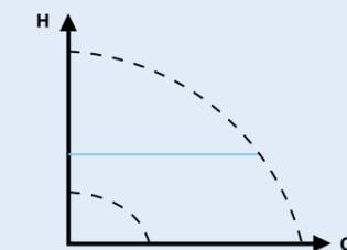
Die Konstantdruckregelung eignet sich für Anlagen mit variablem Durchfluss und sehr geringen Rohrdruckverlusten sowie für offene Anlagen, bei denen der Druckverlust weniger wichtig ist als die statische Förderhöhe.
