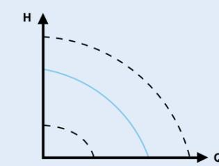
Die Betriebsart mit konstanter Kennlinie ist für Anlagen mit konstantem Durchfluss und konstanter Förderhöhe geeignet. Die Pumpe wird auf den gewünschten Betriebspunkt eingestellt. Dadurch erübrigen sich die Drosselventile, die für Pumpenanlagen dieser Art sonst erforderlich sind.
