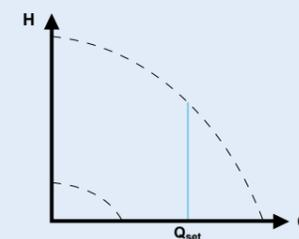
Die Pumpe sorgt unabhängig von der Förderhöhe für einen konstanten Volumenstrom in der Anlage. Ein externer Sensor kann nicht verwendet werden. Stattdessen nutzt die Pumpe ihren eingebauten Sensor. Hinweis: Erhältlich für Pumpen ab Produktionscode 1838.
