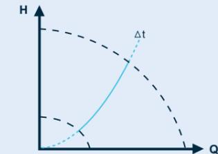
Die Regelungsart sorgt für eine konstante Temperaturspreizung in Heizungs- und Kühlanlagen. Die Pumpe hält eine konstante Differenztemperatur zwischen der Pumpe und dem externen Sensor aufrecht.
