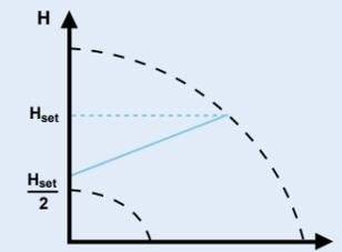
Die Proportionaldruckregelung eignet sich für Anlagen mit relativ großen Druckverlusten in den Verteilerleitungen. Die Pumpe passt ihre Leistung kontinuierlich an die Schwankungen im Durchflussbedarf an.
