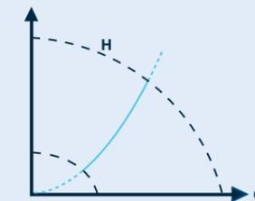
Die Regelungsart Konstanttemperatur eignet sich für Heizanlagen mit variablem Durchfluss, bei denen an einem benutzerdefinierten Punkt eine konstante Flüssigkeitstemperatur gewünscht ist. Die Pumpe sorgt für den Durchfluss, sodass kein externer Regler zur Temperaturregelung erforderlich ist.
