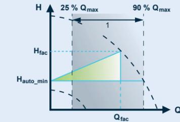
FLOWADAPT ist eine Kombination aus AUTOADAPT und FLOWLIMIT. Die MAGNA3 überwacht kontinuierlich die Durchflussmenge und stellt sicher, dass diese nicht überschritten wird. Damit lassen sich in manchen Fällen die Kosten für ein separates Pumpendrosselventil einsparen.
