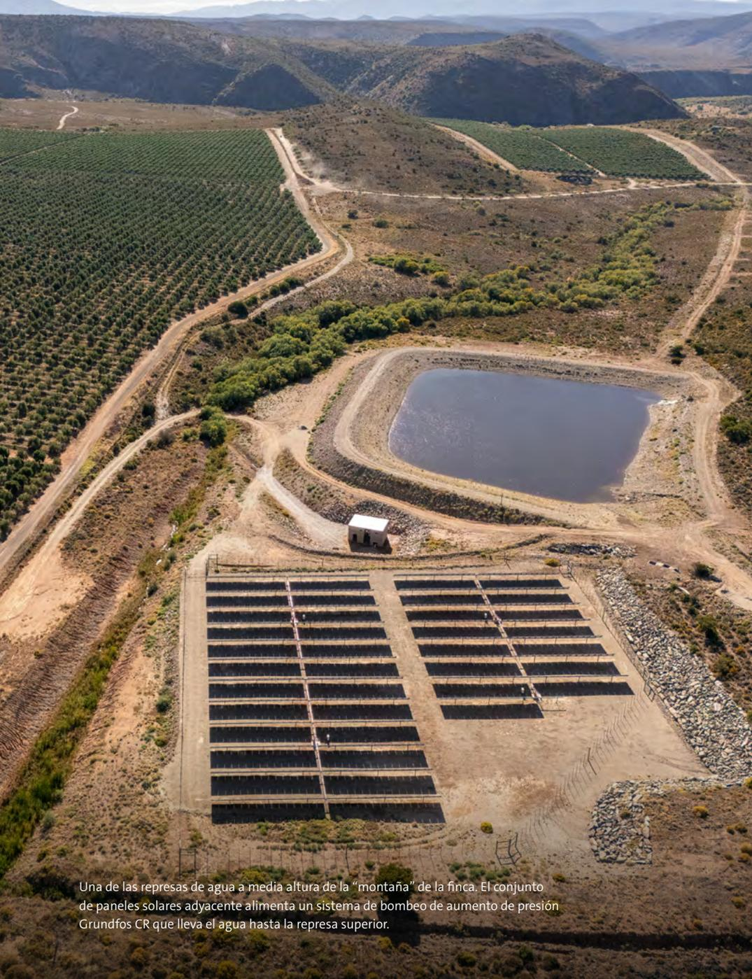
Una de las represas de agua a media altura de la "montaña" de la finca. El conjunto de paneles solares adyacente alimenta un sistema de bombeo de aumento de presión Grundfos CR que lleva el agua hasta la represa superior.
