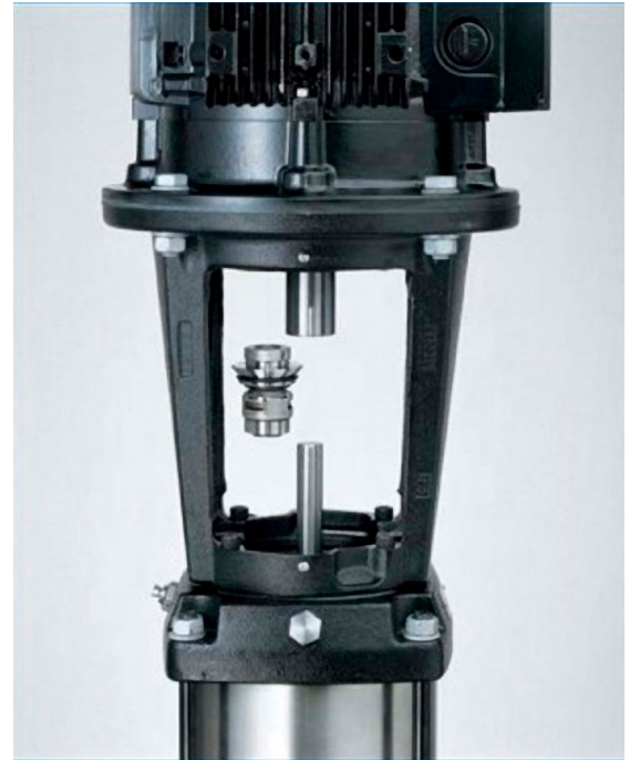
Abbildung 2: Eine schnell zugängliche Patronendichtung erleichtert den Austausch der Wellendichtung bei der vertikalen mehrstufigen Kreiselpumpe. Dieser kann in wenigen Minuten erfolgen und der Motor muss nicht demontiert werden. So lassen sich nach dem Austauschen der Dichtungen Zeit und Aufwand beim Ausrichten der Motoren und Wellen von Norm-/Blockpumpen mit Grundplattenbauweise und Pumpen mit geteiltem Gehäuse einsparen.
